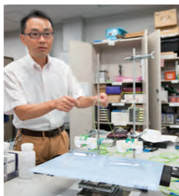
水に反応するセンサー付きの光ファイバーの実験装置。センサーは共生創造理工学科の渡辺一弘教授の研究室が作ったもの。研究室同士の連携が研究に生かされています
